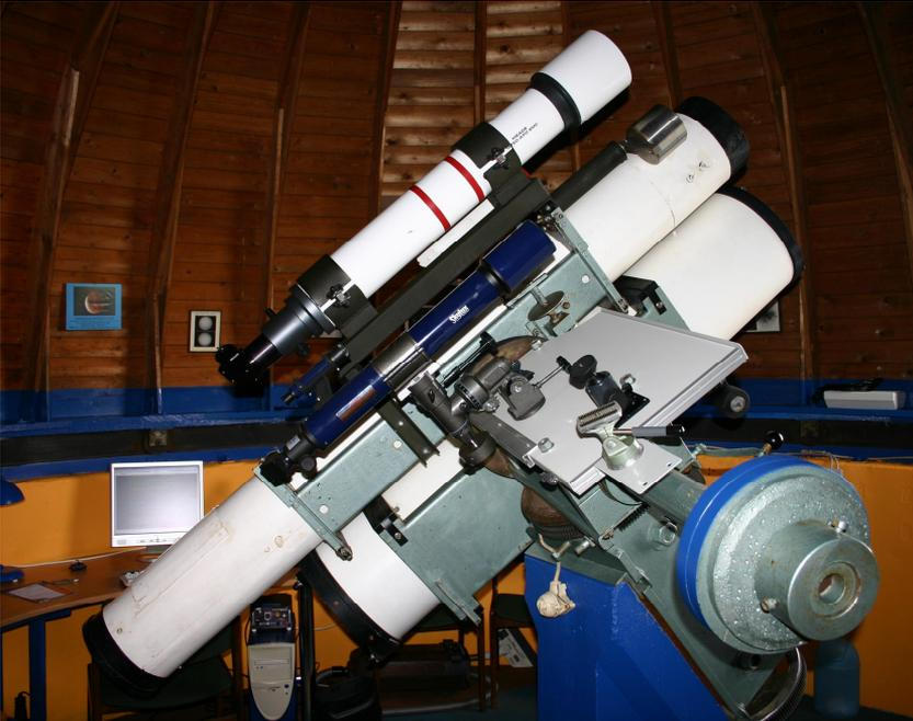
▲ 2005: Oben 12,5 cm Refraktor, Mitte 21 cm Reflektor, unten 30 cm Reflektor
